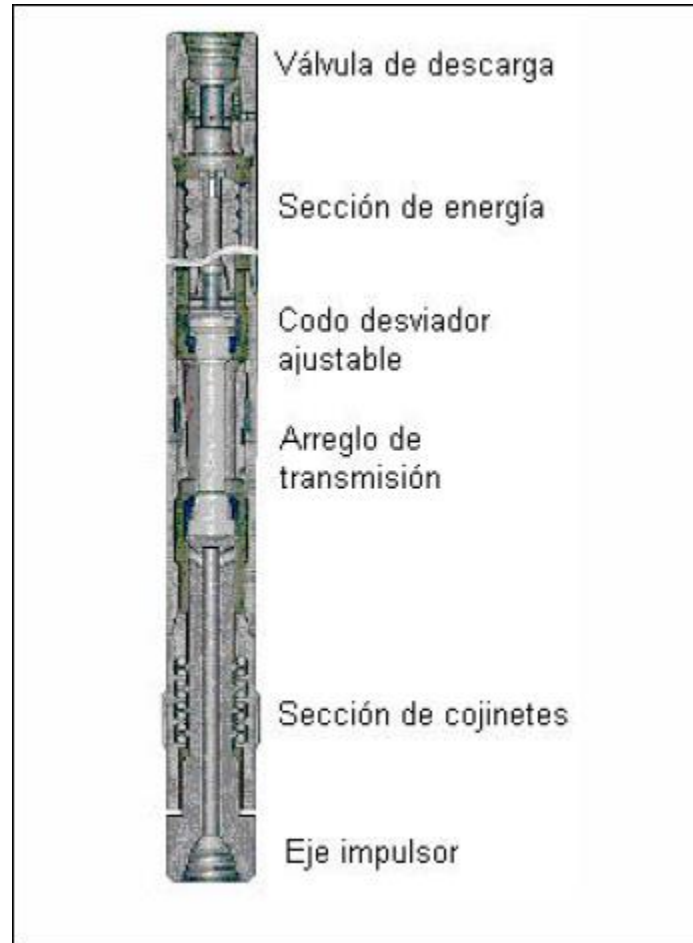
Fig. 7. Sección transversal de un motor de fondo
